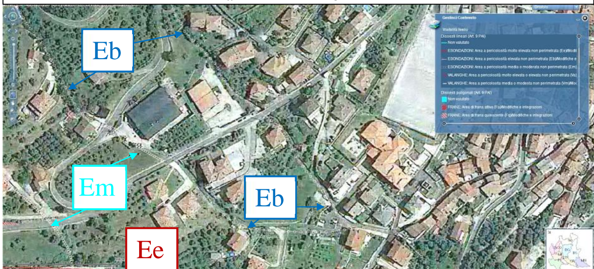
Rappresentazione di elementi lineari di pericolosità da esondazione torrentizia "Ee", "Eb" ed "Em" della attuale carta P.A.I. nella zona di Cambianica; in alto su Carta Tecnica Regionale, in basso su ortofoto da GeoPortale (tra l'altro si noti l'estrema difficoltà di lettura degli elementi lineari sul GeoPortale).
